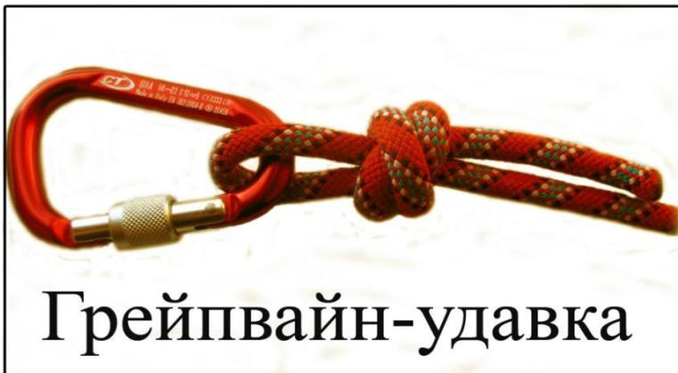
Используется для крепления веревки к карабину самостраховки, простой и надежный узел, который представляет собой затягивающуюся на карабине петлю, фиксируемую половиной узла "Грейпвайн".
